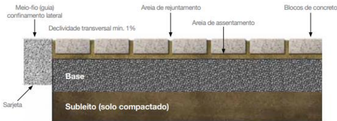
Figura 2: Estrutura típica dos pavimentos intertravados.
